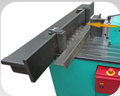
Richten von Profilen und Schweisskonstruktionen Straightening of profiles and welded constructions
